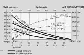
SAE 10, 70 °F (21 °C) CAPACITY CURVE
